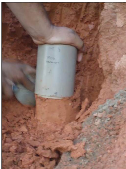
Figura 42: Ponto selecionado (PE-02) e preparação para coleta de amostra para análise do coeficiente de permeabilidade do terreno.
