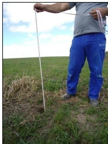
Figura 41: Medição do nível da água estabilizado.
