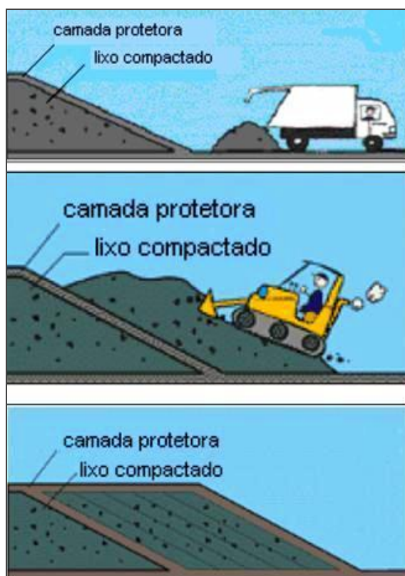
Figura 32: Formação da célula e compactação da rampa.
